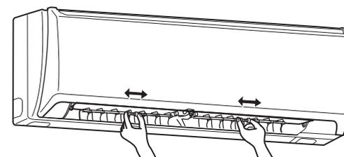
Отрегулируйте положение вертикальной заслонки до начала работы кондиционера. Так как горизонтальная заслонка движется автоматически, она может прищемить Вам пальцы.
