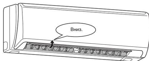
**2** Снимите горизонтальную заслонку. При разблокировании фиксаторов удерживайте горизонтальную заслонку.
