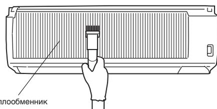
Очистить поверхность теплообменника можно, установив на пылесос щетку из КОМПЛЕКТА БЫСТРОЙ ОЧИСТКИ. Подробные указания по очистке приведены в руководстве к КОМПЛЕКТУ БЫСТРОЙ ОЧИСТКИ (упакованному вместе с наружным прибором).
