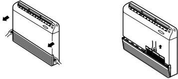
(Если установлен дезодорирующий фильтр или фильтр очистки воздуха (ОПЦИОНАЛЬНО), пожалуйста снимите его перед тем, как производить чистку воздушного фильтра.)
